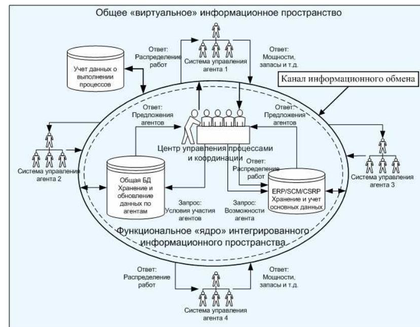
Рис.3.1-1. Общая схема модели интегрированного информационного пространства виртуального предприятия.
